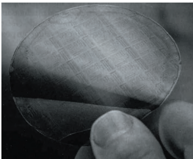
(50 Schaltkreise auf einer biegsamen Plastikfolie)
