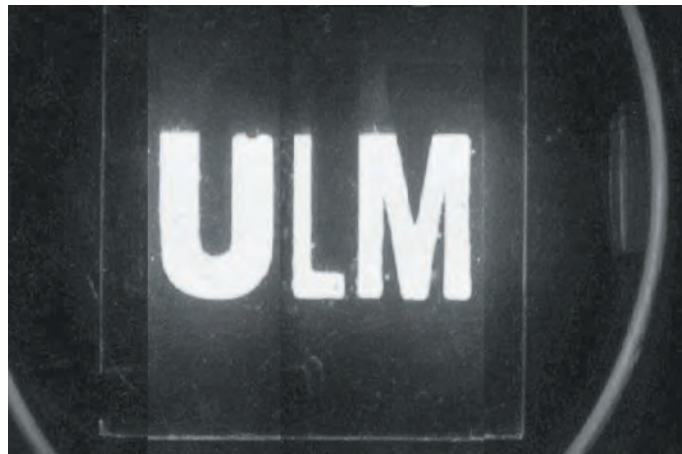
(gelb-orange leuchtendes Plastik bei einer Spannung von acht Volt)
