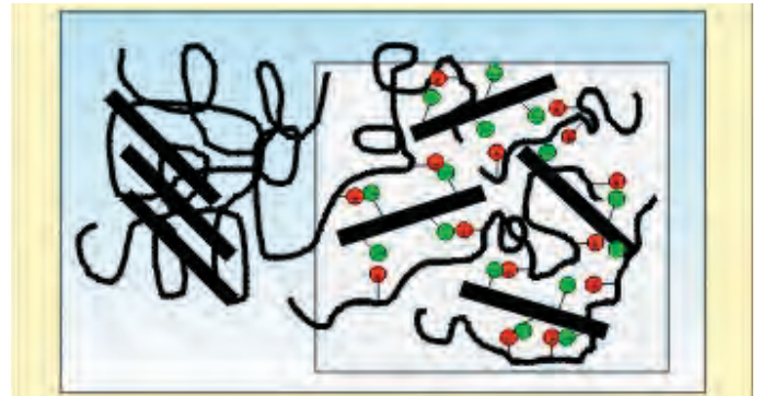
Abbildung: Schematische Darstellung eines verträglichen Säure-Base-Blends von molekular in einer basischen Polymerknäuel-Matrix dispergierten Stäbchenmolekülen (rechts) und einer unverträglichen Stäbchen / Knäuel-Mischung (links)
