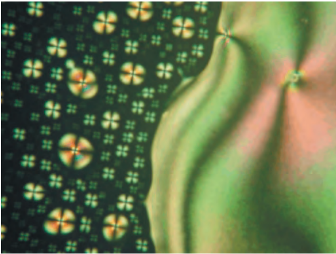
Bild 2: Bildung eines nematischen Flüssigkristalls aus der isotropen Schmelze unter dem Polarisationmikroskop. Wegen der optischen Anisotropie (Doppelbrechung) erscheinen die Flüssigkristalle hell zwischen den gekreuzten Polarisationsfiltern des Mikroskopes. In der schwarzen Fläche links ist noch die isotrope Schmelze zu sehen.
